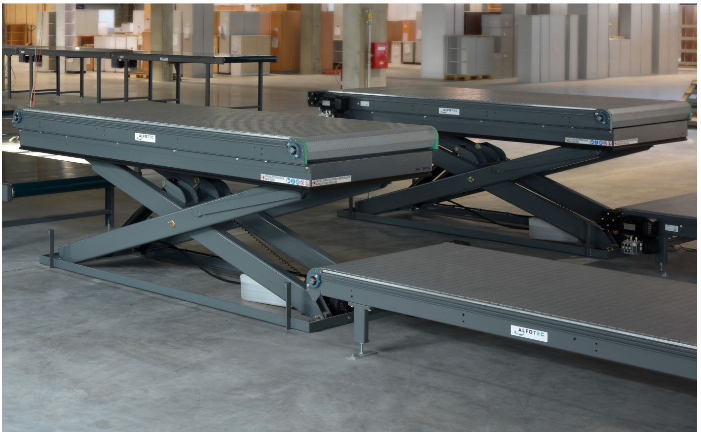
Hubtische mit aufgesetzten Gliederbandförderern in einer Fertigungslinie integriert
