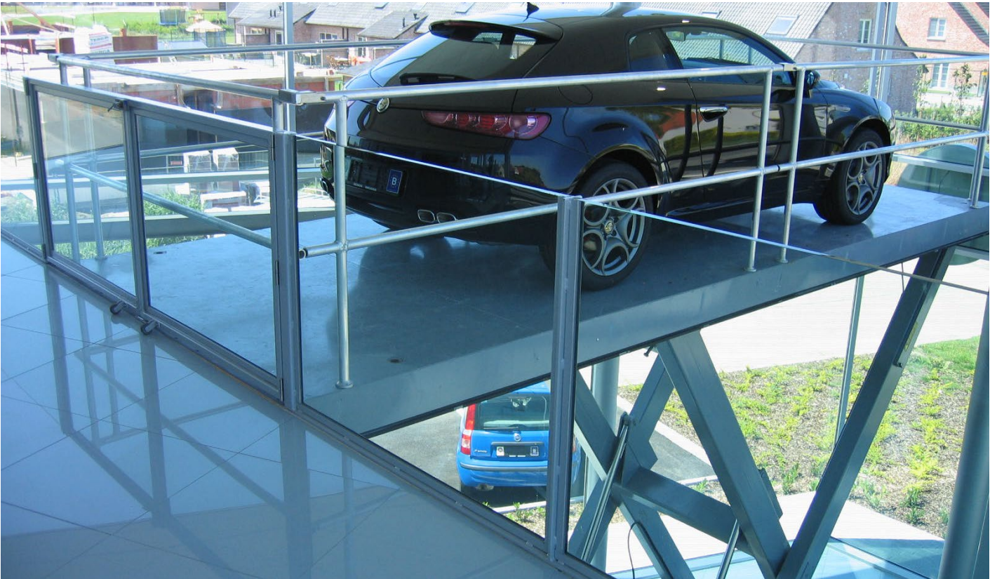
KFZ-Hubtisch im ausgefahrenen Zustand mit kompletter Schutzeinrichtung
