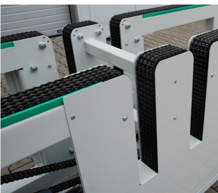
Kettenumlenkungen mit Vierfach- Rollenkette und besonders hohen Hub
