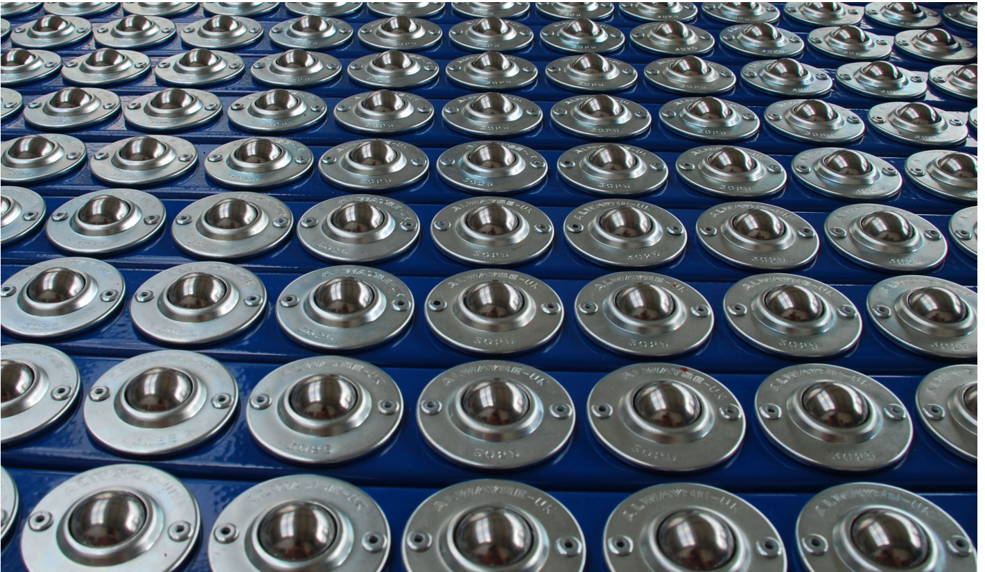
Kugelrollentisch bestehend aus Kugelrollenleisten, Flanschskugelrollen vernietet in U-Profil, für eine starke Lastaufnahme
