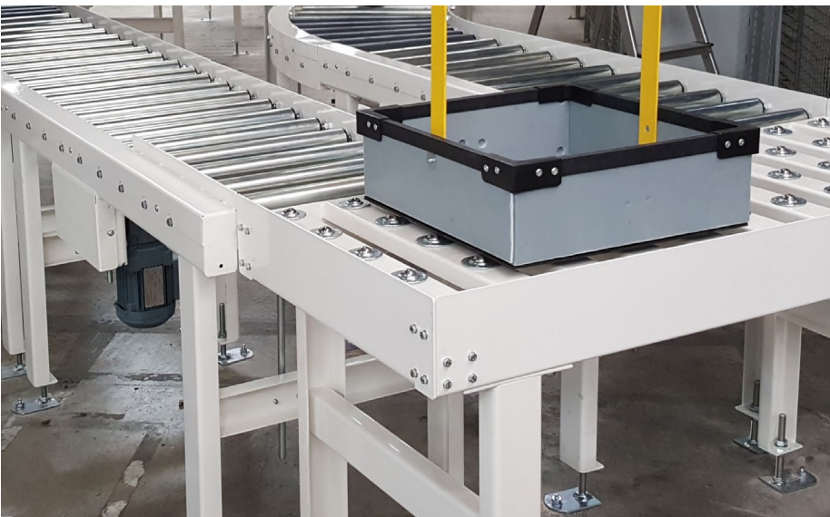
Manuelle Übergabe einer Kunststoffbox zwischen zwei Rollenbahnen
