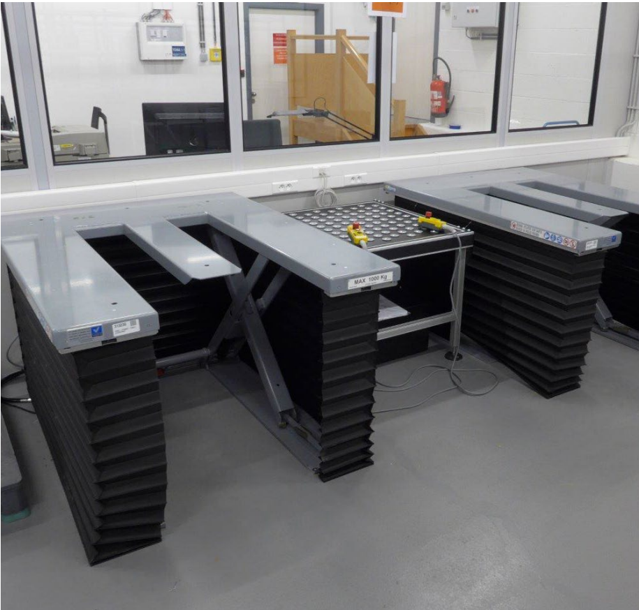
E-Form-Variante mit Faltenbalg als Eingriffsschutz
