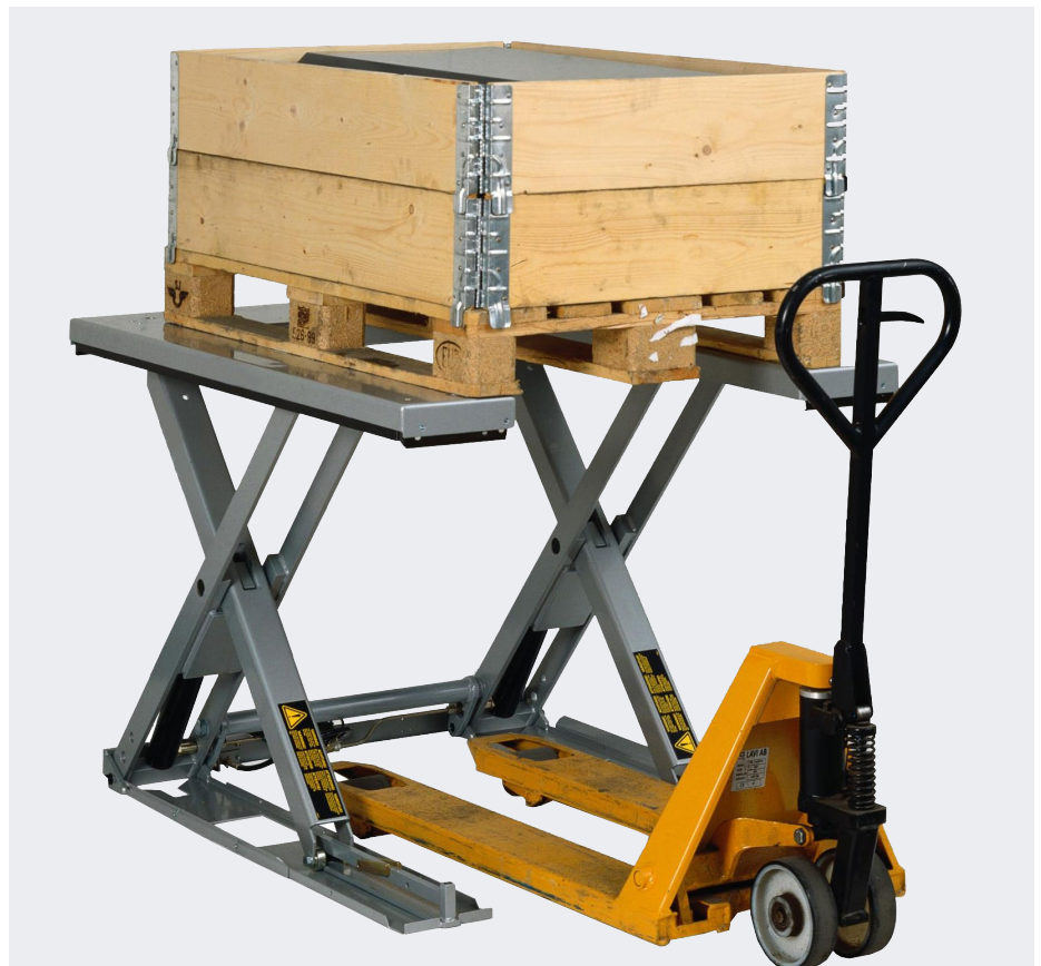
U-Form-Hubtisch im ausgefahrenen Zustand mit Gabelhubwagen
