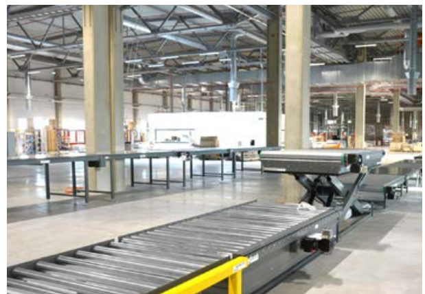
Rollenbahn mit Anfahrerschutz und Montagelinie mit Hubtischen
